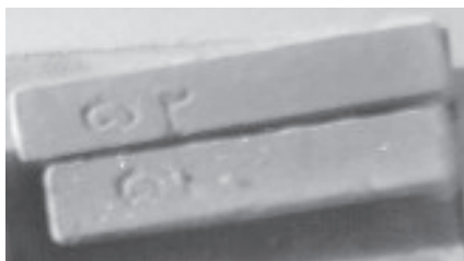
شکل ۴- تصویر نمونه‌های SBNA در دمای ثابت 1500^\circ\text{C} و زمان سینتر ۵ ساعت
