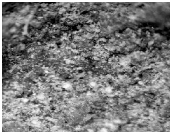
شکل ۴- تصویر میکروسکوپ نوری بازتابی از یافت دانه شکری سنگ مرمر (بزرگنمایی ۶۴ برابر)
