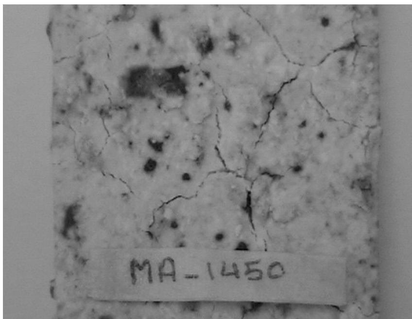
شکل ۶- بتون دیرگداز کم سیمان پایه آندالوزیت ملایر پخته شده در دمای 1450^{\circ}\text{C} ، در این تصویر ترک های موجود در نمونه به وضوح قابل مشاهده می باشند
